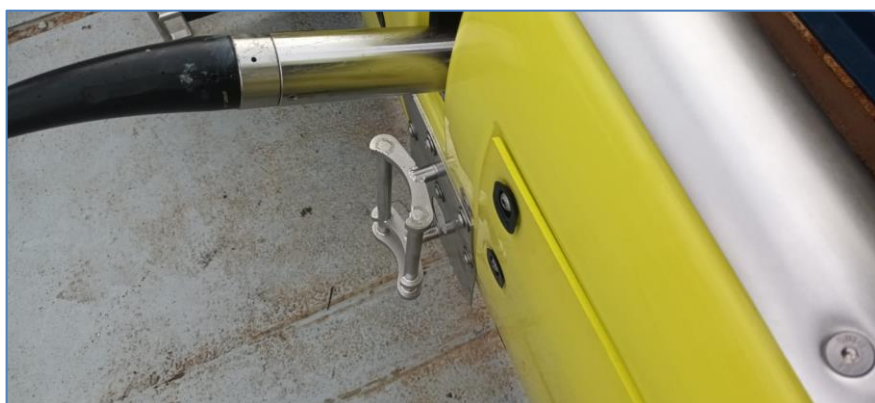
Рисунок 1.1 Посадочное место для установки USBL-транспондера на корпусе ScanFish
